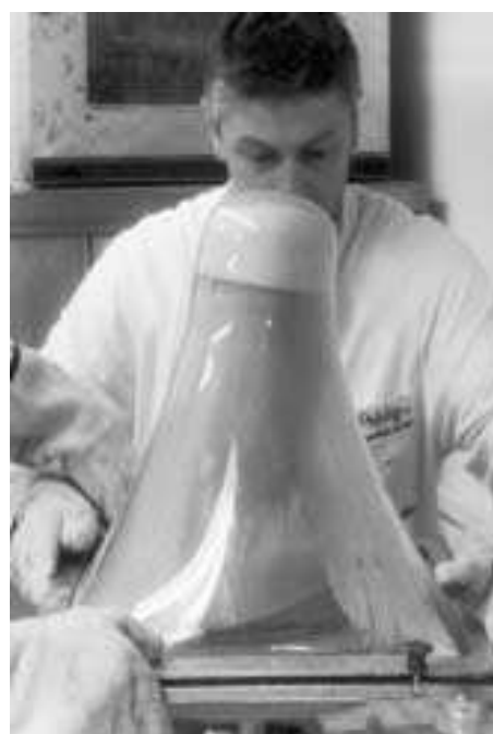
Abb. 4 Tiefziehvorgang des PETG-Probecontainers.
