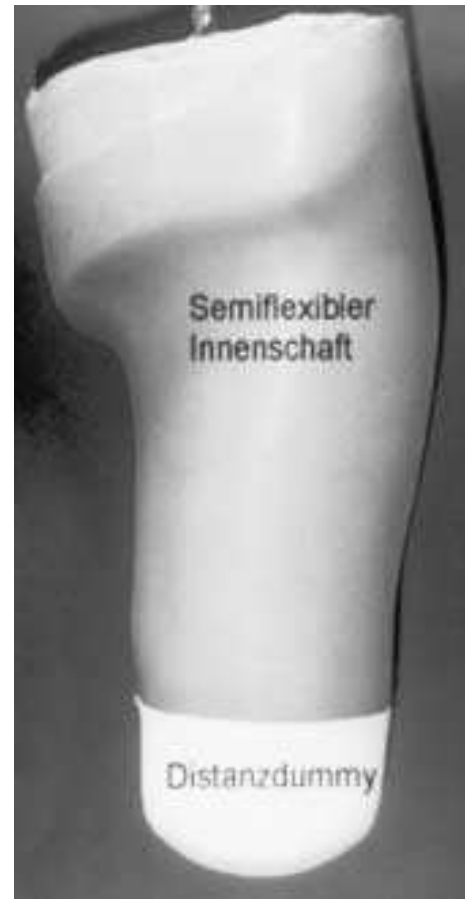
Abb. 3 Semiflexibler Innenschafte mit distalem Distanzdummys.
