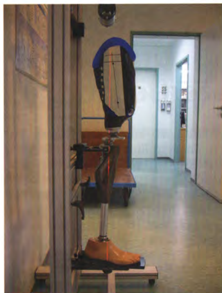
Abb. 2 Grundaufbau der Prothese mit dem PRO.S.A. Assembly Aufbaugerät von Otto Bock.
