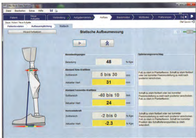
Abb. 3 Statische Aufbaumessung mit CAA, vorgeschlagene Nachjustierungen der Einstellsoftware.
