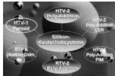
Abb. 2 Vernetzungsprinzipien von Silikonkautschuken.
