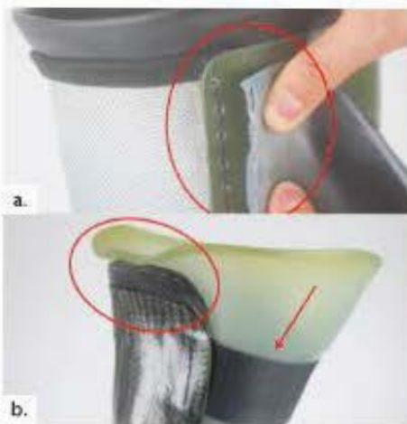
Abb. 5a Defekte Manschette durch Kantendruck erzeugt Vakuumverlust.
