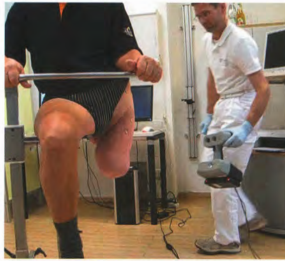
Abb. 3 Formerfassung durch videobasierten Scan.
