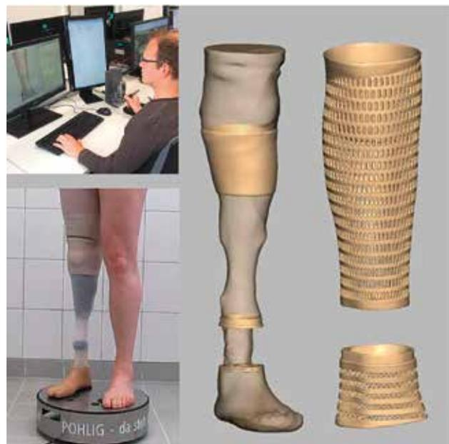
**Abb. 11** Individuelle Silikon-Beinkosmetik mit ultraleichtem wasser-tauglichem Formunterbau, im SLS-Verfahren hergestellt.
