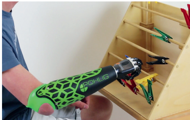
Abb. 7 Clothespin-Assessment mit Myo-Plus-System.
