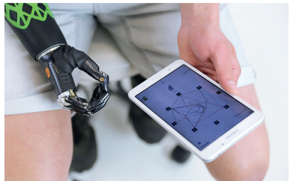
Abb. 3 Programmierung der PR-Bewegungsmuster per Tablet.
